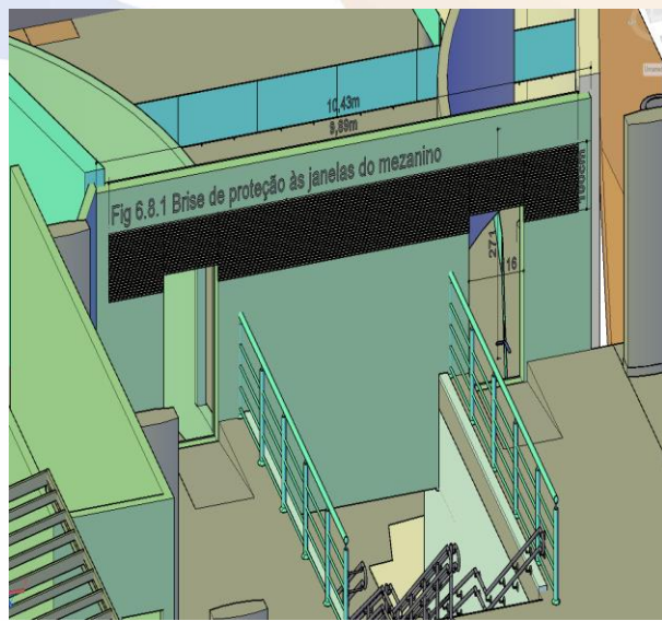
Fig. 6.8.1 Brise de alumínio para dar proteção sobre as janelas e portas de blindex
